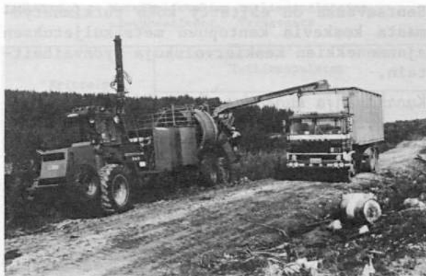
Kuva 6. Kantopuun haketus kantohakkurilla suoraan odottavan auton kuormatilaan. Valok. Metsäteho
