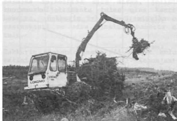
Kuva 4. Kantopuun metsäkuljetus pankkavarusteisella metsätraktorilla. Valok. Metsäteho
