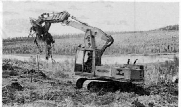
Kuva 2. Kantojen nosto, paloittelu ja kasaus Pallarin kantonharvesterilla. Valok. T. Jämsen
