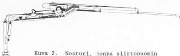
Kuva 2. Nosturi, jonka siirtopuomin peräpäätä menee nosto- ja siirtopuomin taitekohdan yli
