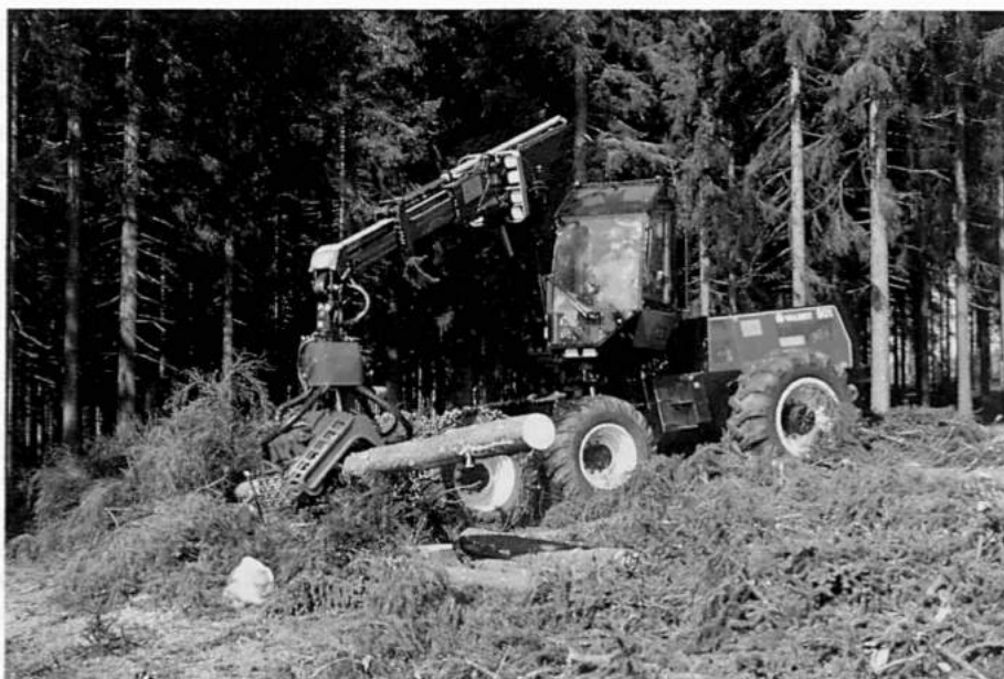
Valmet 901 soveltuu sekä harvennus- että päätehakkuihin. Valok. Metsäteho The Valmet 901 is suited for both thinning and final cuttings. Photo Metsäteho
