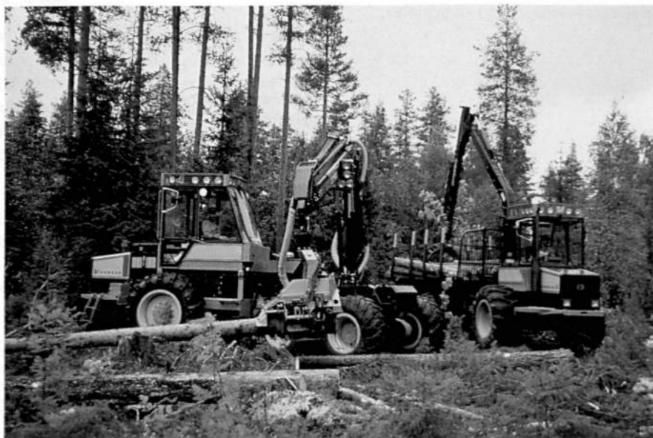
Tutkimuksessa oli mukana kuusi Ponsse S15-sarjan kuormatraktoria. Valok. Ponsse Oy Six Ponsse S15 forwarders were studied. Photo Ponsse Oy
