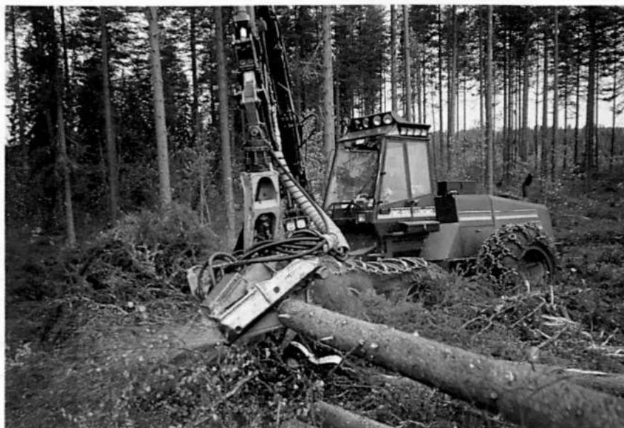
FMG 990 oli tutkimusaineiston yleisin kuormainharvesteri. Valok. Metsäteho FMG 990 was the most common single-grip harvester in the study. Photo Metsäteho
