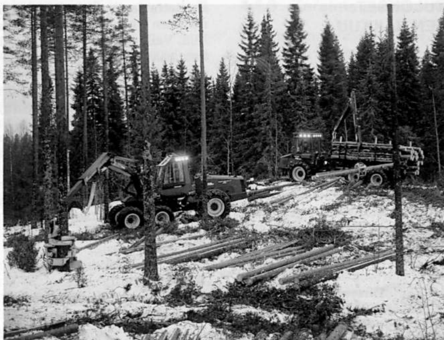
Havusahatukkien kuormausta koneellisen hakkuun jälkeen. Valok. Timberjack Sales Oy Forest haulage after mechanized cutting. Photo Timberjack Sales Oy
